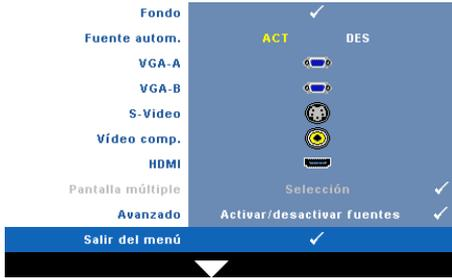
**FUENTE AUTOM.**—Seleccione **DES** (valor predeterminado) para bloquear la señal de entrada actual. Si presiona el botón **Fuente autom.** mientras el modo **Fuente autom.** está establecido en **DES**, podrá seleccionar manualmente la señal de entrada. Seleccione **ACT** para detectar automáticamente las señales de entrada disponibles. Si presiona el botón **Fuente** cuando
